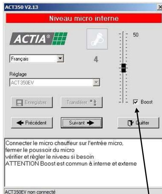
La fonction Boost permet une augmentation du volume micro de 16dB
